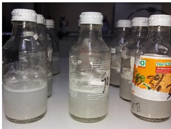
Gambar 12. Perendaman Sampel menggunakan Serbuk Cangkang Kerang Darah
