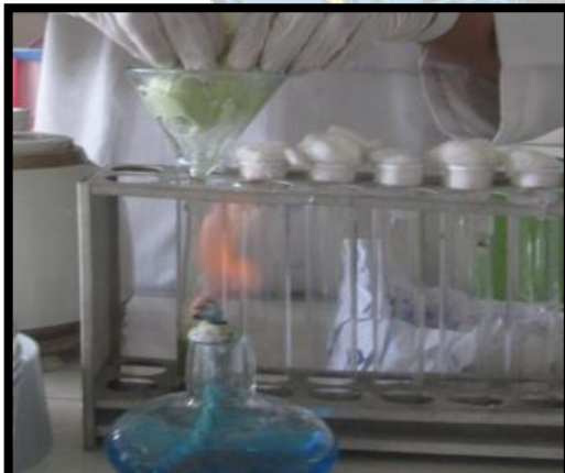
Gambar 3 : Proses Penyaringan setelah maserasi (3x 24 jam)
