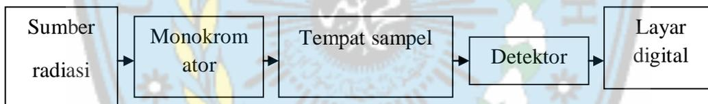
**Gambar 2.3.2. Susunan instrumen spektrofotometer UV-Vis**
