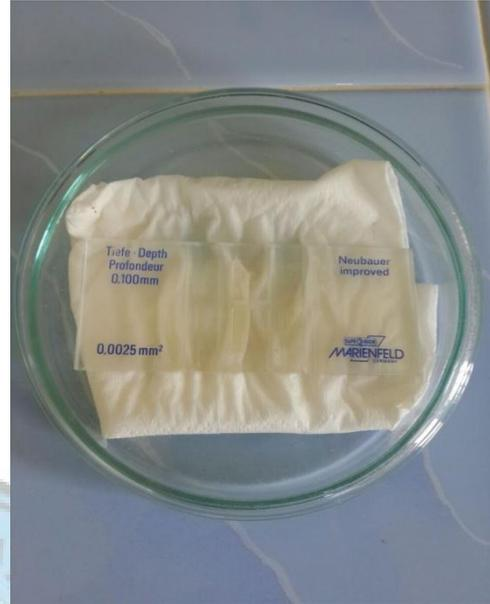
Gambar 6. Kamar hitung yang telah terisi dan siap untuk dihitung
