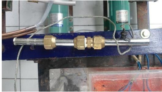
**Gambar : 3.14** *Termocouple*
