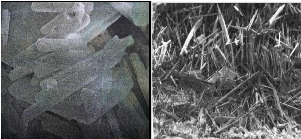
**Gambar 4.6.** Hasil pengujian SEM suhu  $30^{\circ}$  dan  $50^{\circ}$  c dengan perbesaran 2.500 kali.
