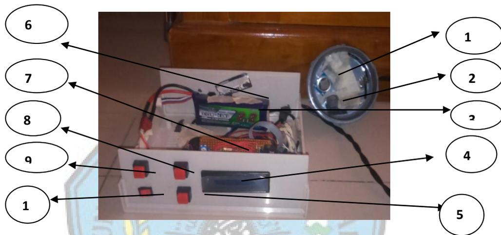
Gambar 4.1 Alat ukur emisi gas buang CO dan HC berbasis mikrokontroler
