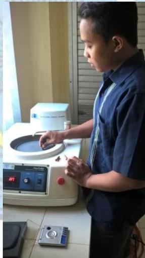
Gambar 3.9 Pengamplasan Sampel Pengujian
