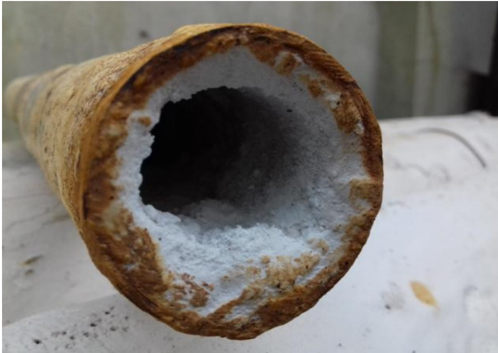
Gambar 2.1. Endapan kerak kalsium karbonat dalam Pipa (Raharjo S.,2016)
