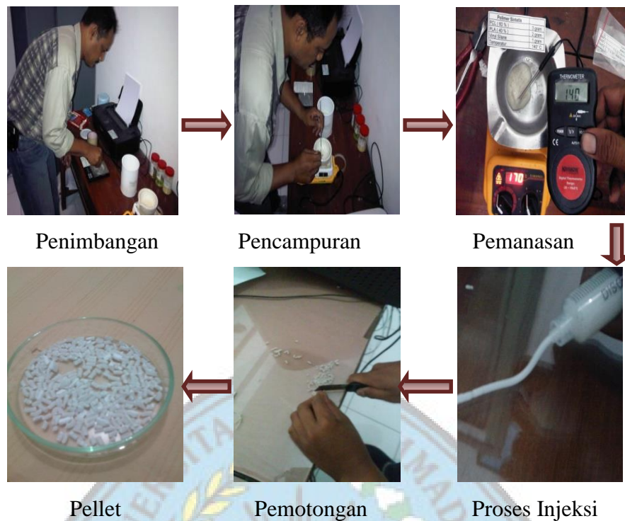
Gambar 3.14. Proses pembuatan polimer sintesis (dokumen, 2016)
