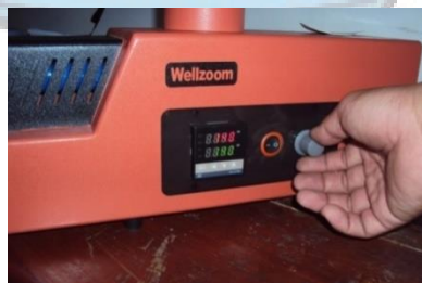
Gambar 3.16. Pengaturan set temperatur dan kecepatan ekstrusi (dok, 2016)
