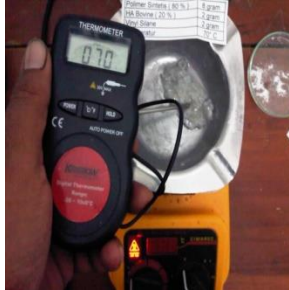
Gambar 3.15. Pemanasan pellet FDM pada temperatur 70°C ( dok, 2016 )
