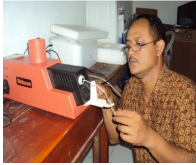
Gambar 3.17. Pembuatan filamen FDM (dokumentasi, 2016)
