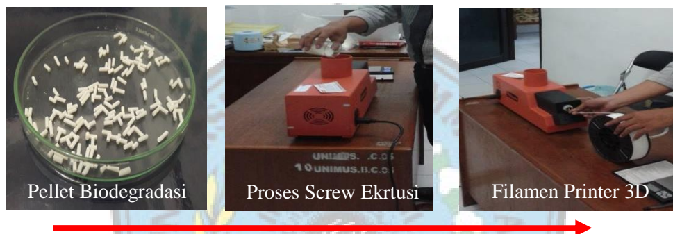
Gambar 2. Proses pembuatan filamen biodegradasi printer 3D
