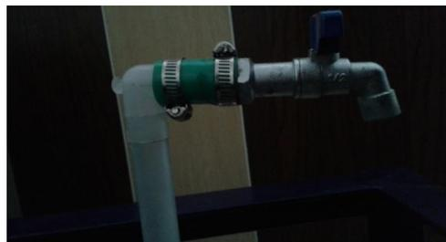
**Gambar 3.6.** Pengaturan laju aliran kran
