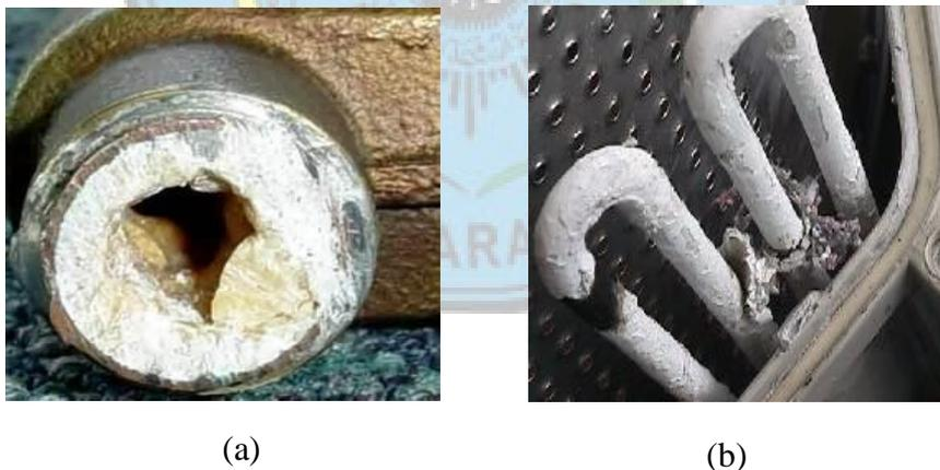
**Gambar 2.1.**Endapan kerak kalsium Sulfat (a) dalam Pipa (b) permukaan Heat exchangers (Crabtree dkk,1990).
