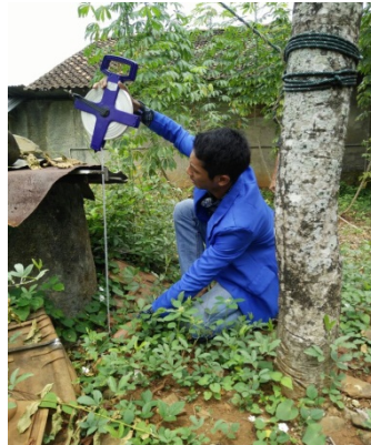
Pengukuran bibir sumur
