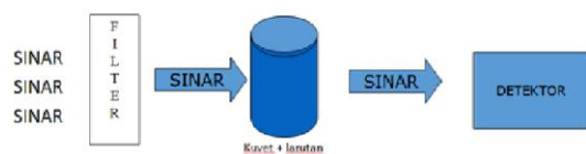
Gambar 3 : Skema Fotometri (Ricrad, 2013)
