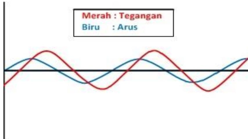
**Gambar 2.12** Gelombang arus dan tegangan pada beban kapasitif.
