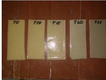
Gambar 4.1. Sampel uji isolator terhadap sudut kontak (RTV10 – RTV50)
