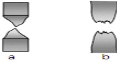
**Gambar 2.11** a. Ilustrasi *plane strain* dan b. *plane stress* (Luluk, 2016)
