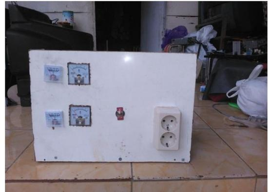
**Gambar 3.5.**gambar output dan saklar generator tanpabbm 12 v ke 220 v
