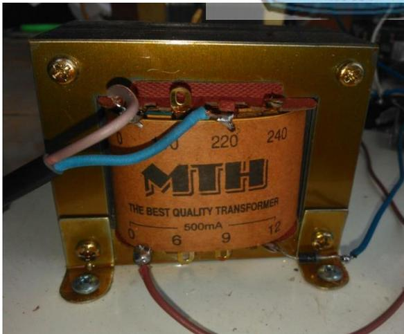
Gambar 3.11. Trafo Step-Down 5 Ampere
