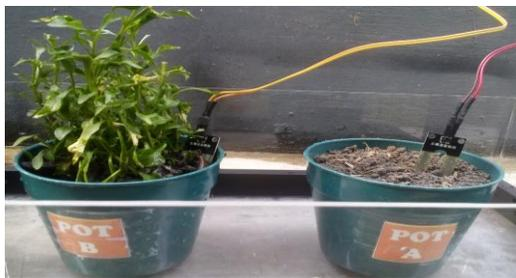
Gambar 4.2 Penempatan Input Sensor pada Pot Tanaman
