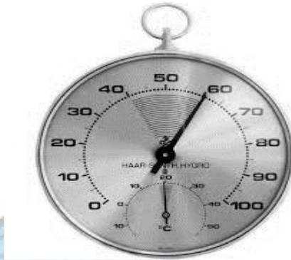
Gambar 2.4. Hygrometer untuk mengukur kelembaban ruangan
