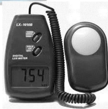
Gambar 2.2. Luxmeter untuk pengukuran pencahayaan
