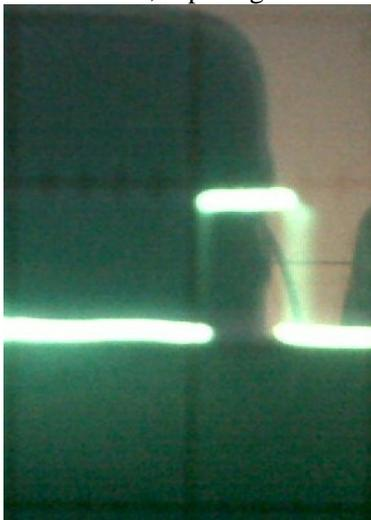
**Gambar 4.10. Sinyal Output Dari Pendeteksi Beda Fase**
