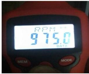
Gambar 4.9. RPM motor dengan PWM *duty cycle* 75%
