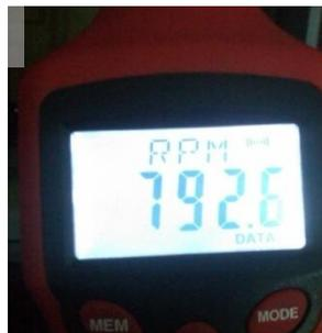
Gambar 4.8. RPM motor dengan PWM *duty cycle* 50%
