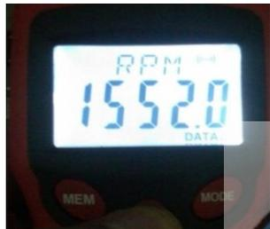
Gambar 4.10. RPM motor dengan PWM *duty cycle* 100%
