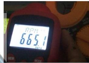
Gambar 4.7. RPM motor dengan PWM *duty cycle* 25%
