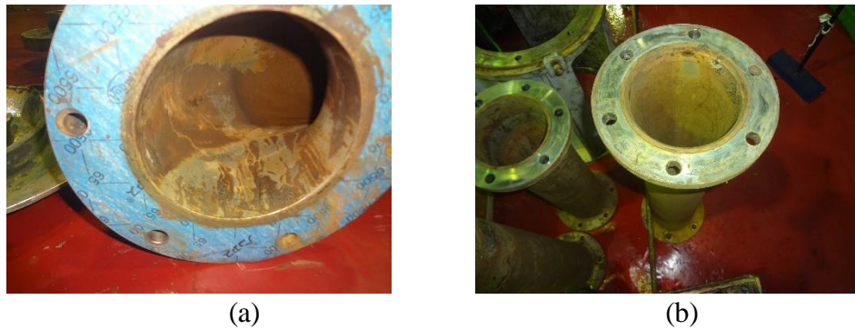
Gambar 2.1. Endapan kerak dalam Pipa (Raharjo,2016)
