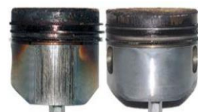
Gambar 1. Kerusakan piston karena aus ( www.jepistons.com )
