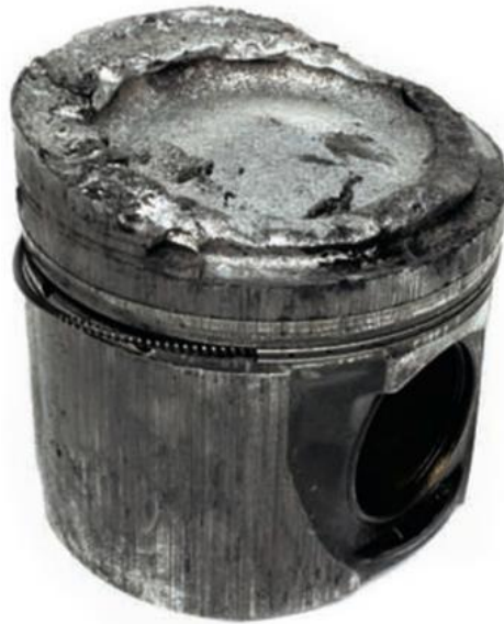
Gambar 2.2 Kerusakan piston karena aus (AA1Car.com)
