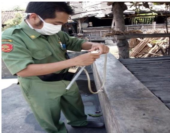
Gambar 7. Pengukuran kadar debu
