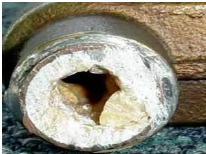
Gambar 2.1. Endapan kerak kalsium karbonat dalam Pipa
