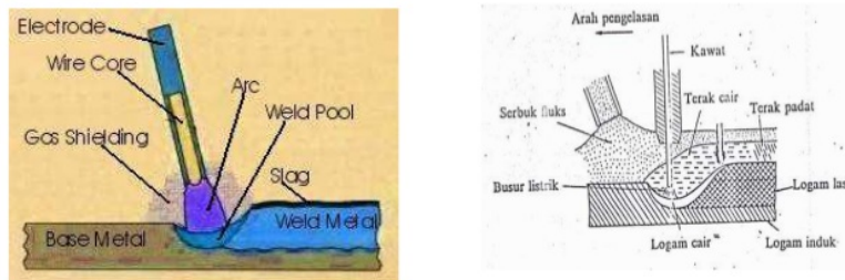
Gambar 2. Proses pengelasan busur logam terbungkus (Aljufri, 2008)
