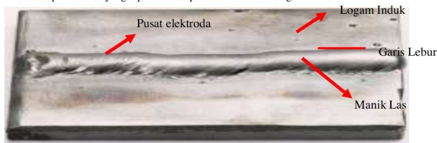
Gambar 3. Arah pembekuan dari logam las
