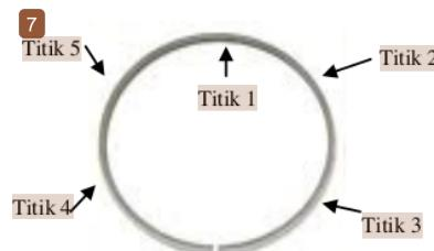
**Gambar 6. Letak titik pengujian kekerasan permukaan ring piston**
