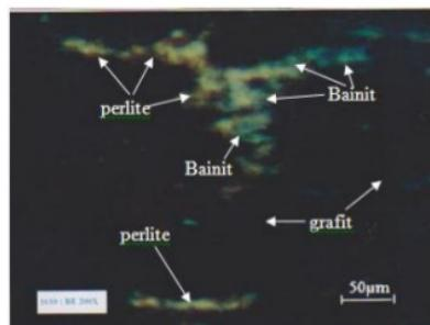
**Gambar 5. Struktur mikro KW1 holding time 4,5 jam, perbesaran 200X**
