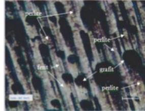
**Gambar 3. Strukturmikro KW1 holding time 1,5 jam, perbesaran 200X**
