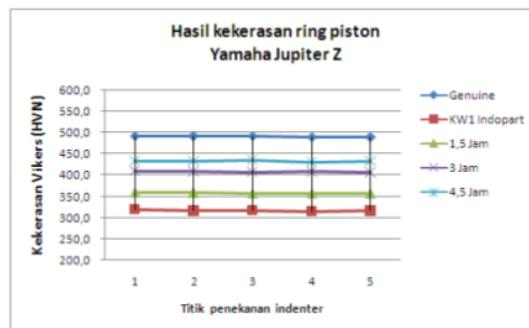
**Gambar 7. Grafik perbandingan hasil kekerasan ring piston Yamaha Jupiter Z**
