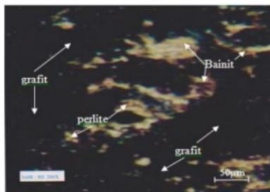
**Gambar 4. Strukturmikro KW1 holding time 3 jam, perbesaran 200X**
