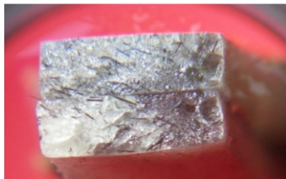
Gambar 4. Patahan Komposit Yang Diperkuat Serat Tanpa Perlakuan Alkali
