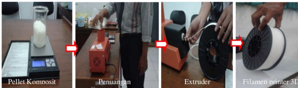
Gambar 2. Proses pembuatan filament biodegrasi print 3D
