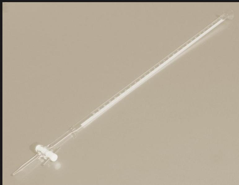
Berfungsi untuk mengukur volume suatu larutan, biasa digunakan untuk titrasi dengan presisi tinggi dan juga untuk keperluan analisis volumetrik kuantitatif.
