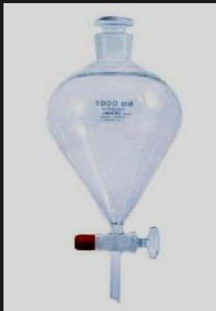
Berfungsi untuk proses memisahkan komponen-komponen fase pelarut dengan densitas yang berbeda.
