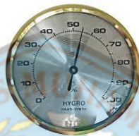
Gambar 2.4 Hygrometer untuk mengukur kelembaban ruangan
