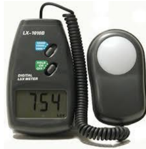
Gambar 2.2 Luxmeter untuk pengukuran pencahayaan
