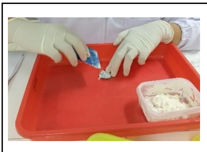
Gambar 13. Pelapisan Prekursor pada Kasa 304-400 mesh
