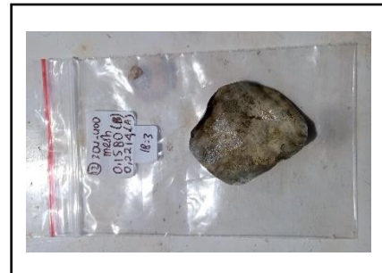
Gambar 31. Membran Biji Kelor/TiO 2 setelah digunakan untuk menyaring
