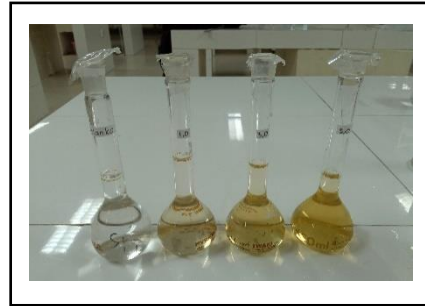
Gambar 18. Baku Cu(II) 1,0 ppm ; 3,0 ppm ; 5,0 ppm untuk optimasi panjang gelombang dan optimasi waktu kesetabilan
