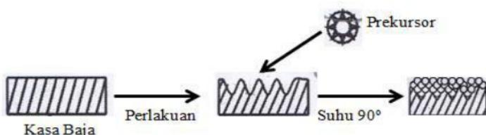
Gambar 1. Sintesis zeolit ZSM-5 secara *coating* (Gao dkk., 2011)
