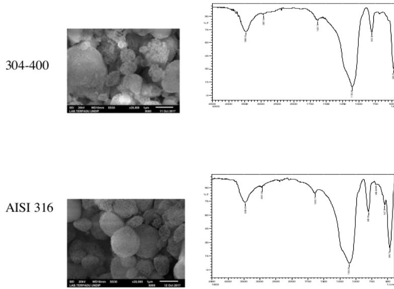
Gambar 4. Citra SEM membran ZSM-5 dan FTIR dengan variasi kasa dengan pre-treatment direndam dengan NaOH, HCl, dielektroksidasi dengan  $H_2SO_4$
