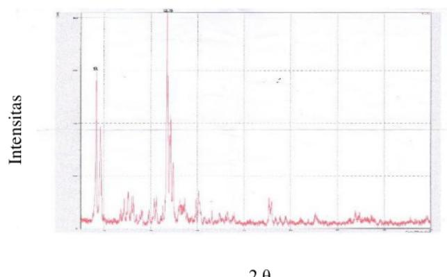
Gambar 2. Pola difraksi Membran ZSM-5
