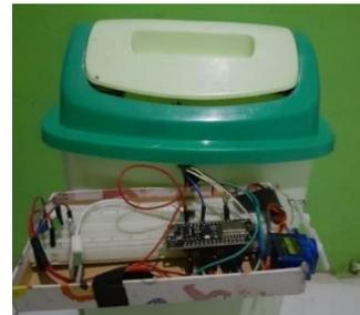
Gambar 12. NodeMCU ESP8266 pada Smart Trash Can
