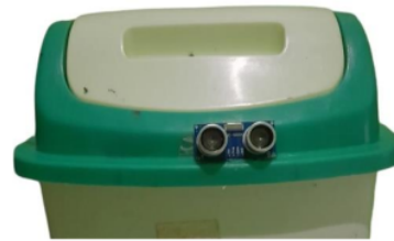
23 Gambar 13. Pemasangan Sensor Ultrasonik 1
