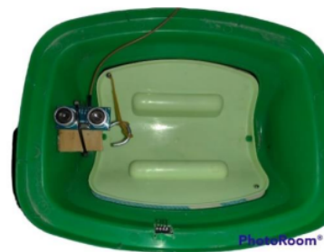
Gambar 14. Pemasangan Sensor Ultrasonik 2
