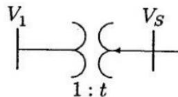
Gambar 2. Single line sebuah tap transformator[1]
