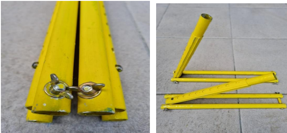
Gambar 4.4 Pengunci gawang dan Gawang Ketika kuncian di kencangan dan dikendurkan (Sumber: Penelitian 2022)
