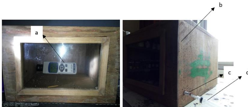
Gambar 9.2. CO meter Lutron CO800 (a), Kotak uji volume 18.000 \text{cm}^3 (b), sampel rokok (c), spuit (d) (sumber : dokumen pribadi)
