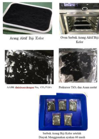
Gambar 2.2 Proses pembuatan serbuk Biji Kelor/ \text{TiO}_2 (a) dan Proses pembuatan arang aktif Biji Kelor (b)
