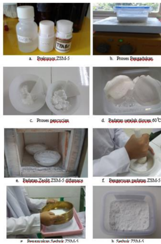
Gambar 3.4 Sintesis ZSM-5 pada Suhu 90°C
