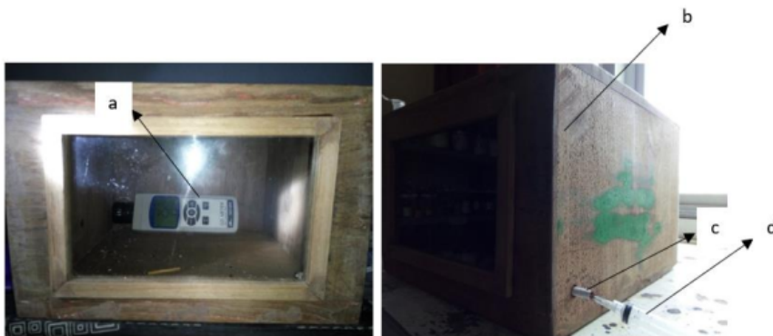
Gambar 9.2. CO meter Lutron CO800 (a), Kotak uji volume 18.000 \text{cm}^3 (b), sampel rokok (c), spuit (d) (sumber : dokumen pribadi) (Saputri, Mukaromah, & Yusrin, 2017; Utami, Mukaromah, and Yusrin Y. 2017)
