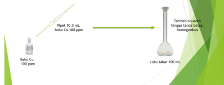
Gambar 6.1 Pembuatan Baku Cu(II) 10,0 ppm
