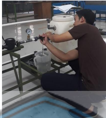
Gambar 3.15. Pemasangan Venturi Ejektor pada Alat Uji
