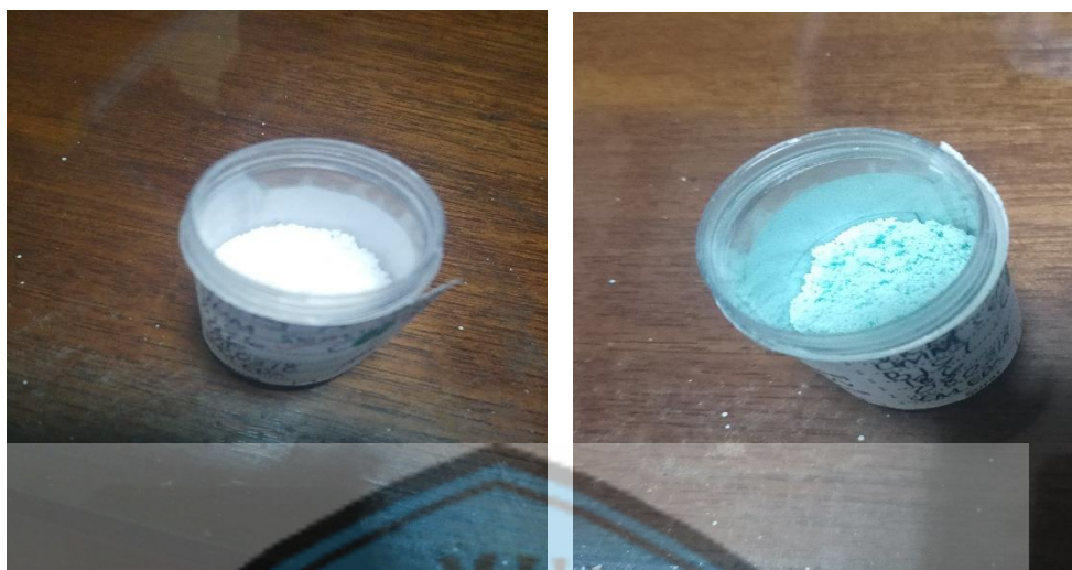
(a) Kerak \text{MgCO}_3 Tanpa penambahan (b) Kerak \text{MgCO}_3 dengan penambahan aditif \text{ION Cu}^{2+} 5 ppm
