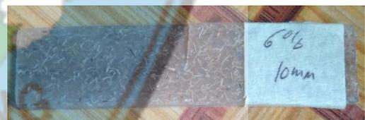
Gambar 4.10 Hasil uji impact pada komposisi serat wt6% panjang ligament 10mm
