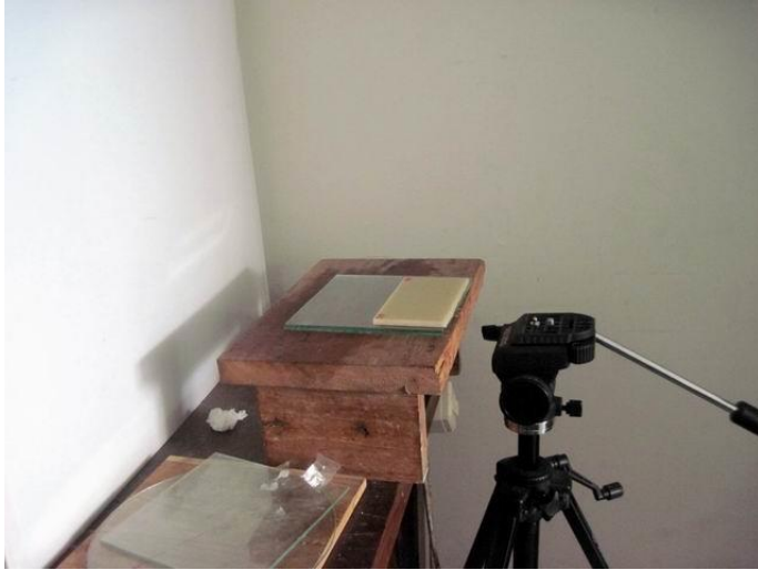
Gambar 5. Rangkaian Pengujian Sudut Kontak
